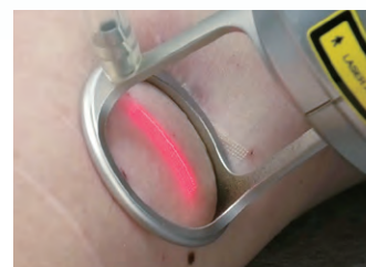
スキャナーハンドピース: スキャン形状/四角、スキャンエリア/2×20mm
